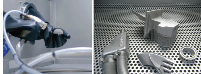
Katmanlı imalat ile üretilen parçalara kumlama uygulaması
