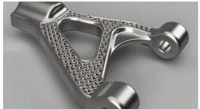
Yüzey işlem görmüş katmanlı imalat ile üretilmiş parçalara örnekler
