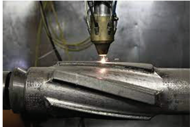
Sondaj sistemlerinde aşınma yüzeylerinin tamiri
